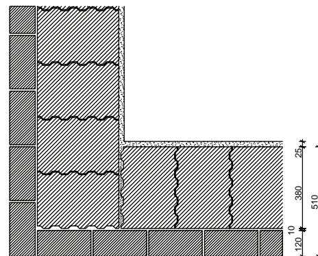
При кладке угла из блоков **Porotherm 38** доборные элементы не требуются. Обращаем внимание, что вертикальный шов, образующийся в месте соединения гладкой поверхности блока с пазогребневой стороной другого блока, нужно заполнить тёплым раствором во избежание образования щели или мостика холода.
