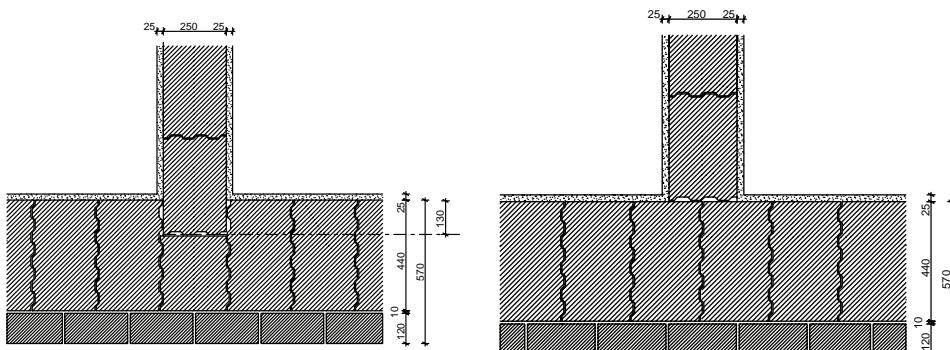
При соединении стены из блоков **Porotherm 25** с несущей внешней стеной один блок в каждом втором ряду выпиливается на глубину примерно 130 мм для обеспечения перевязки внешней несущей стены с внутренней стеной из **Porotherm 25**.
