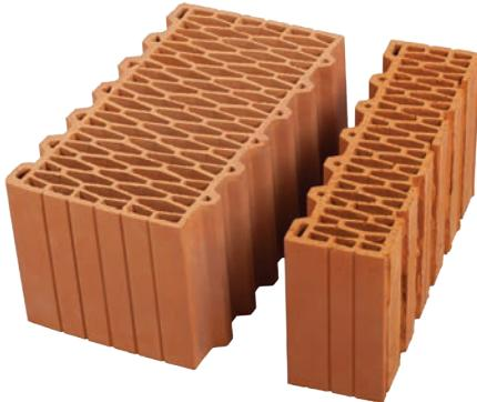
Крупноформатные керамические камни Porotherm 44 предназначены для кладки наружных несущих стен в один ряд толщиной 440 мм без дополнительного утепления.
