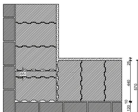
Из-за особенностей размеров блоков, при кладке угла из **Porotherm 44** необходимо использовать дополнительные элементы шириной 65 мм, выпиленные из целиковых блоков **Porotherm 44**.
